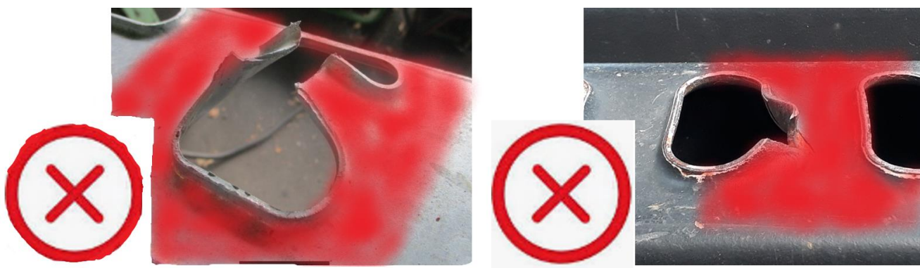
Рисунок 5. Примеры отверстий для прохода крюка, имеющие трещины и неприемлемые для крепления
