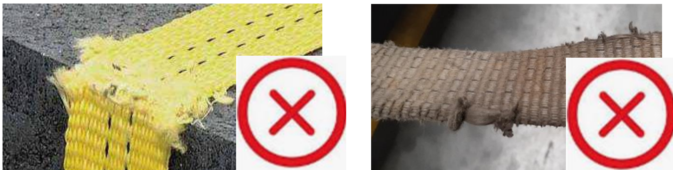
Рисунок 9. Потертая ткань крепежного ремня
