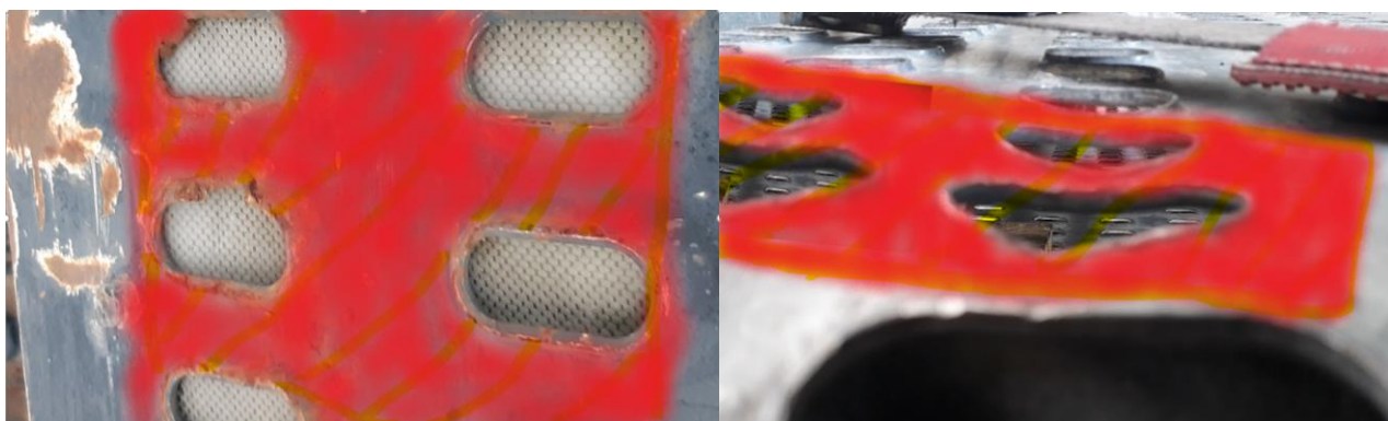
Рисунок 4. Примеры поверхностей, на которые запрещено крепить колесо
