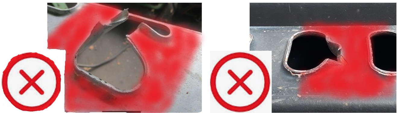
Abb. 5: Aufgerissene/beschädigte Befestigungspunkte zur Sicherung verboten
