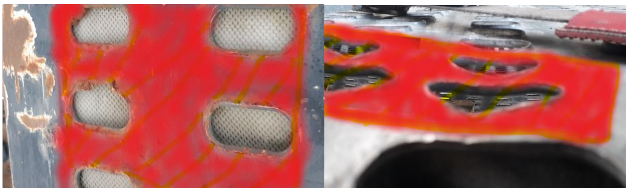
Abb.4: Flächen auf denen das Abstützen eines verzurrten Rads verboten ist
